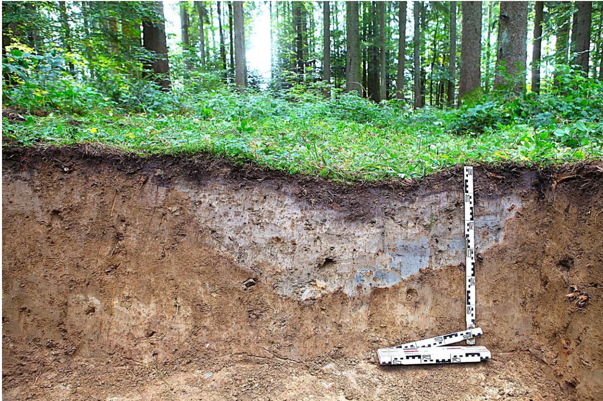
Abb. 4: Das Bodenprofil unter einer Fahrspur, zeigt deutlich eine blaugraue Verfärbung. Auf Grund von Sauerstoffmangel haben sich Fäulnisbakterien gebildet. Foto: Marco Walser, Eidg. Forschungsanstalt WSL, Schweiz
